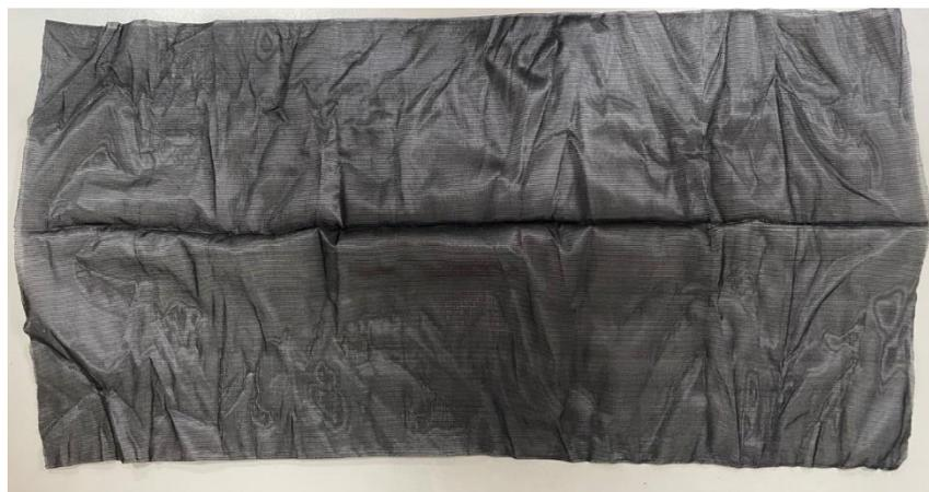
圖四 有浸泡有機溶劑之紗網
